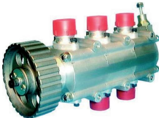
Pompe à rotor à 2, ou 3 étages très utilisée pour tous types de moteurs jusqu'à 3,5 L de cylindrée. Fiable, compacte et performante, elle doit être entraînée par une courroie crantée et tourner à la moitié du régime du moteur sans jamais dépasser 4000 tr/mn. Elle est équipée d'un clapet de décharge pour régler la pression d'huile.
