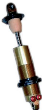
L'amortisseur à double réglage (DA) dispose de deux boutons de réglage montés sur le corps permettant 784 combinaisons de réglage (28 pour chaque compression et détente). Les réglages de compression et détente sont 100 % indépendants ce qui permet une mise au point parfaite.
